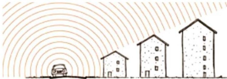
Figure 3 : effet d'obstacle des bâtiments (source : Guide PLU et bruit)
