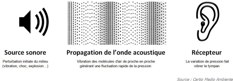
Figure 1 : schéma de propagation du son dans l'air. Plus la fluctuation de pression sera ample et rapide, plus le son perçu sera fort et aigu
